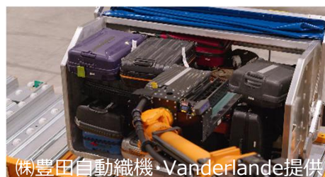
<手荷物コンテナへの自動積付ロボット（豊田自動織機）>
