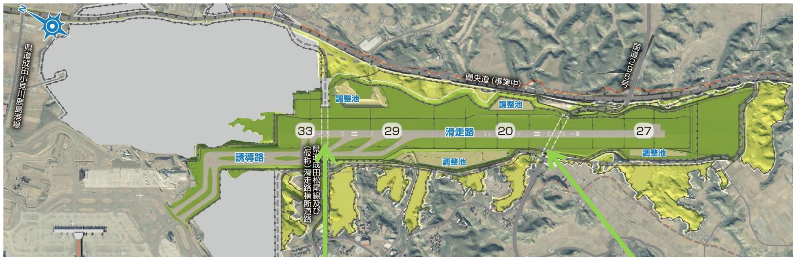
C滑走路地区:軟弱地盤の分布 (図中緑線の内側:精査中)
