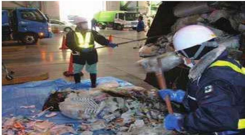
写真：成田富里いずみ清掃工場での展開検査の様子
