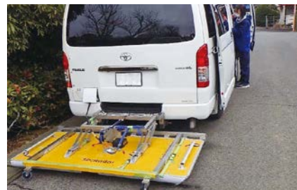
路面下空洞化調査
