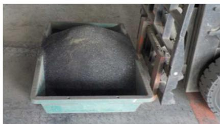
写真：成田富里いずみ清掃工場で生成された溶融スラグ
