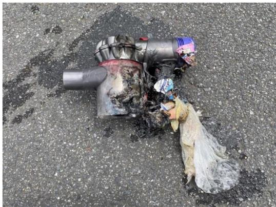
消防署により原因を調査中ですが、可燃ごみとして出されてしまった電化製品がごみ収集車の回転盤で圧迫された際に、内蔵されているリチウムイオン電池に大きな衝撃が加わったことによって発火したものと思われます。
