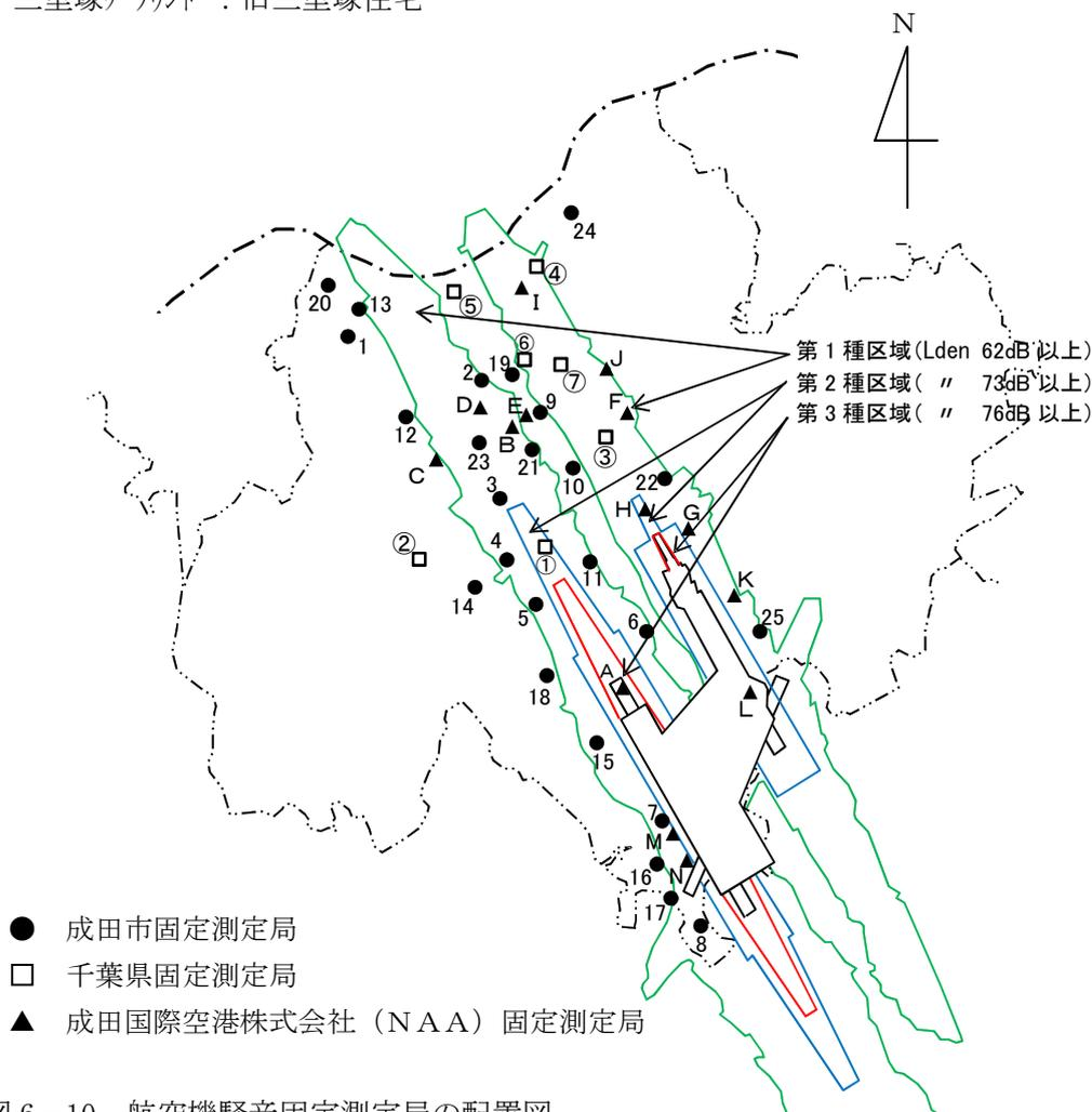
図 6-10 航空機騒音固定測定局の配置図
