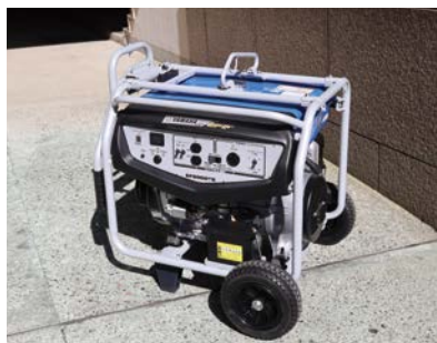
災害時などで使用する発電機
