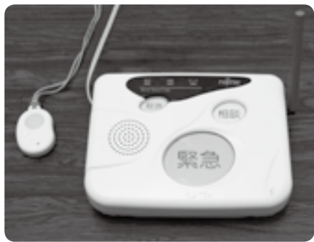
緊急通報装置
