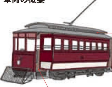
滑車が回転し、架線に接していた集電装置(トロリーポール)
