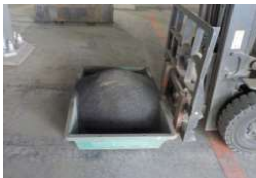
写真：成田富里いずみ清掃工場で生成された溶融スラグ
