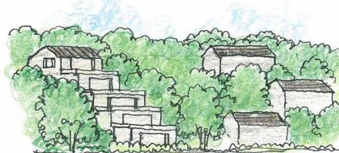
長大な法面や擁壁を生じず、地形になじませた配置や分散させた配置とする
