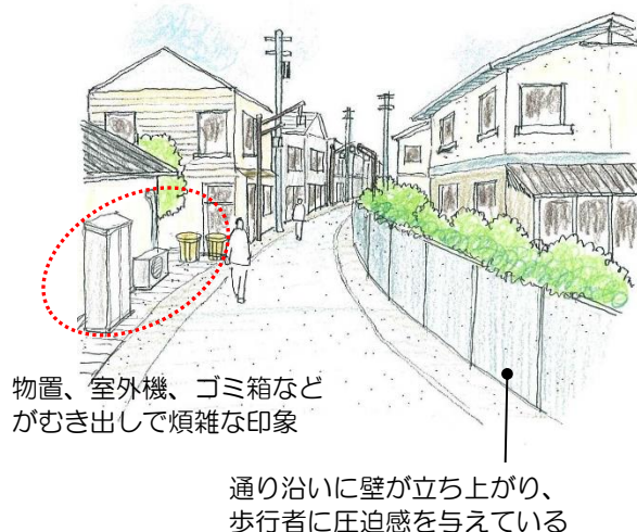
配慮されていない状態
