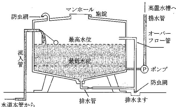
簡易専用水道は、県や市町村等の水道（水道事業）から供給される水のみを水源として、一旦受水槽に貯留し、高置水槽や圧力タンク等で給水する水道で、受水槽の有効容量が10立方メートルを超えるものが該当します。
